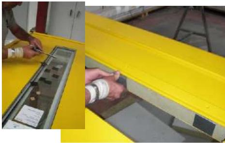
6.- Do wstawiania szkła należy używać narzędzi plastikowych, a nie metalowych.
