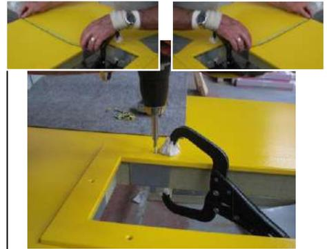
Przymocuj pierścień do ostrza za pomocą zacisku dociskowego i wkręć go w otwory za pomocą dostarczonych śrub.
