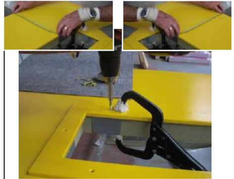
Fixez l'anneau à la lame à l'aide d'un collier de serrage et vissez-le dans les trous prévus à cet effet avec les vis fournies.
