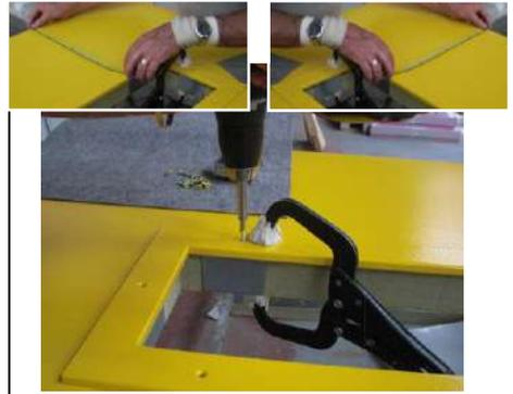
Asegurar el arillo a la hoja utilizando una pinza de presión y atornillar en los agujeros predispuestos con los tornillos suministrados.
