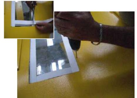
10.- Colocar el arillo y atornillar en los puntos anteriormente taladrados, **procurando no apretar demasiado para no dañar el vidrio.**
