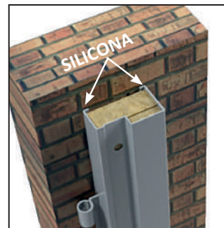
3. Una vez anclados los tornillos en el muro, se sella con silicona ambos bordes del marco. En caso de que quede holgura entre el marco y el muro, se rellenará de lana de roca y posteriormente se sellará con silicona.
