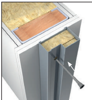
2. Para fijar el marco al cartón yeso, introducimos los tornillos correspondientes, sobrepasando el agujero predispuesto en el marco y el agujero predispuesto en la pletina de fijación hasta introducirlo dentro de la pared.
